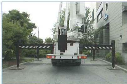
Con il facile livellamento automatico l'unità viene stabilizzata in 40 secondi. Il ritorno degli stabilizzatori in fase di trasporto avviene automaticamente tramite un pulsante.
